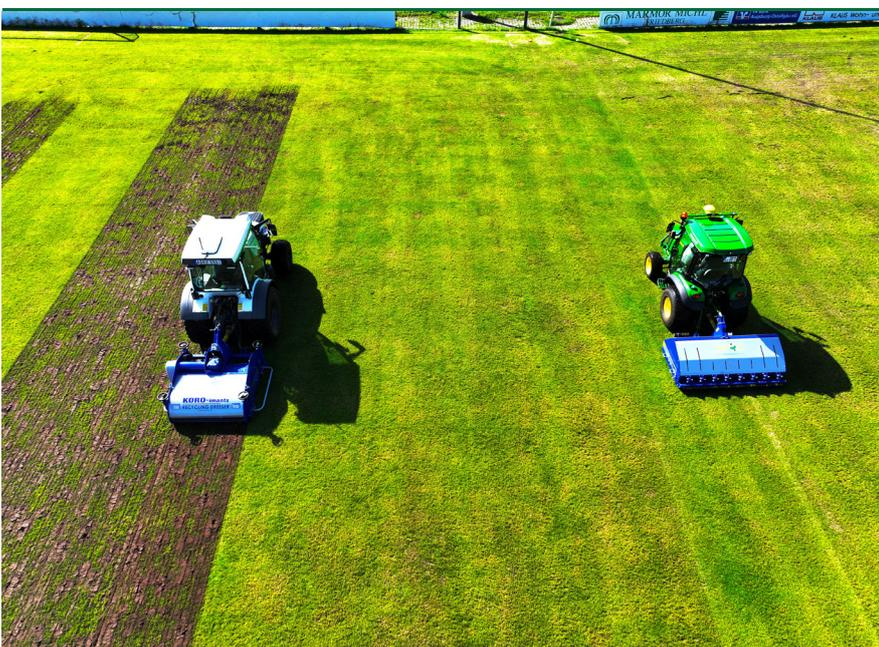
**1** Zum Einen kann eine Tiefenlockerung mit senkrecht in den Boden stechenden Zinken (Spoons) erfolgen. Durch die zusätzliche Anwendung eines Brechwinkels werden die Bodenschichten noch besser gebrochen. Durch Einbringen von Quarzsand kann diese Bodenbearbeitung nachhaltig unterstützt werden.
